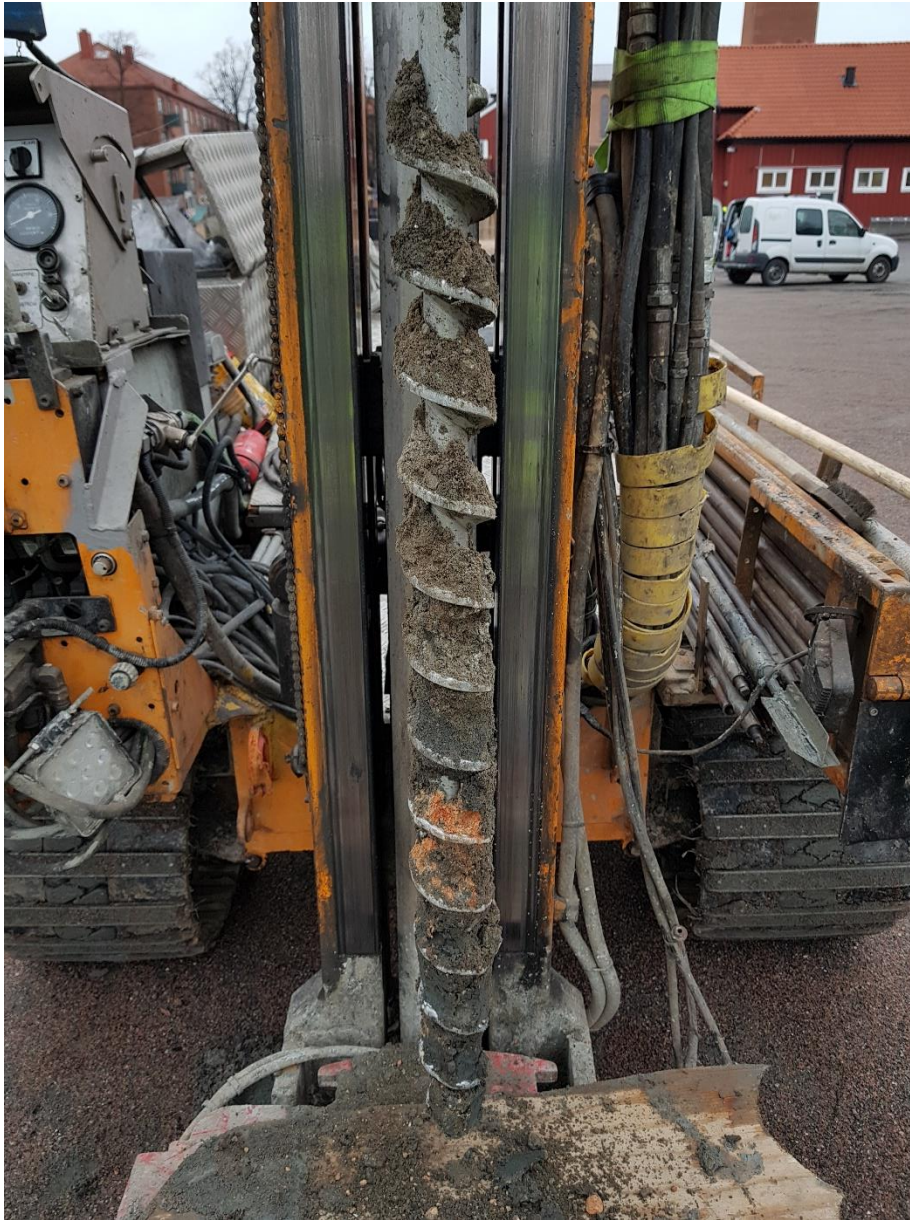
Figur 14. Skruv från provpunkt Skr 2011 med mycket tegel på skruvens nedre del.
