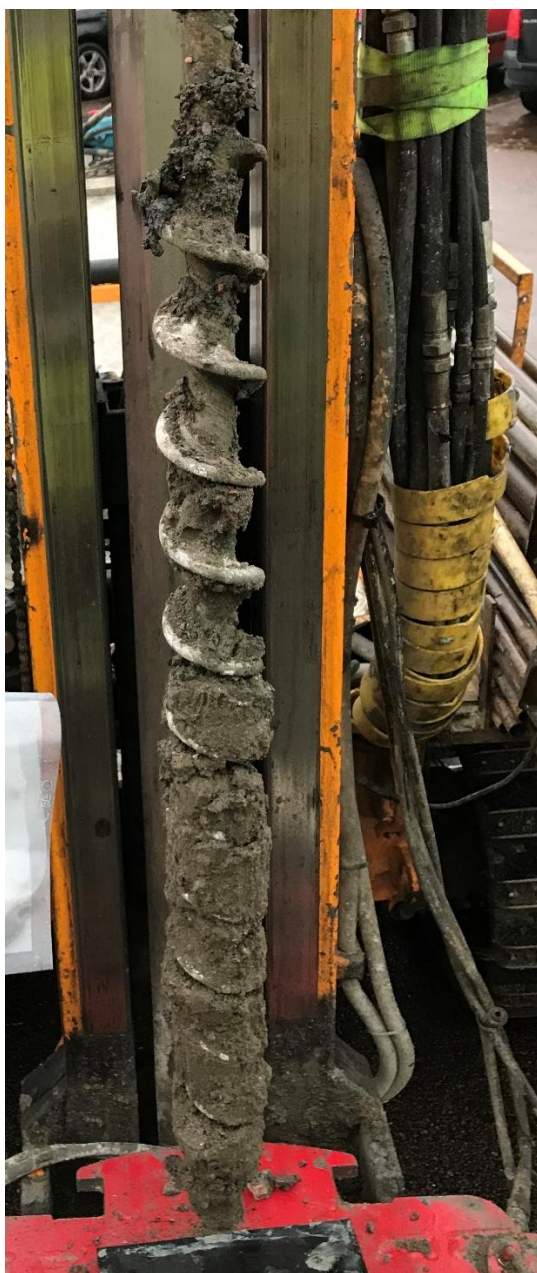
Figur 16. Skruv från Skr 2007, nivå 0,4–1,0 m med inslag av tegel, syns ej tydligt på bilden.
